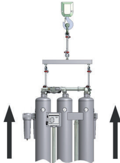
II: Installazione con gru
